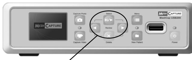
Välj-, Tillbaka- och Nästa-knapparna ( Select , Back , Next ) används för att navigera genom menyerna.
